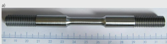
Bild 2: Rundzugprobe a) und Vollwandprobe b) für den Slow Strain-Rate Tensile Test
