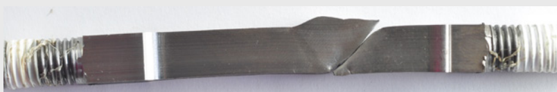
Bild 4: Vollwandprobe nach SSRT, in Stickstoff getestet
